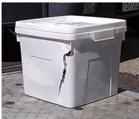
【詰め過ぎによる破損】
